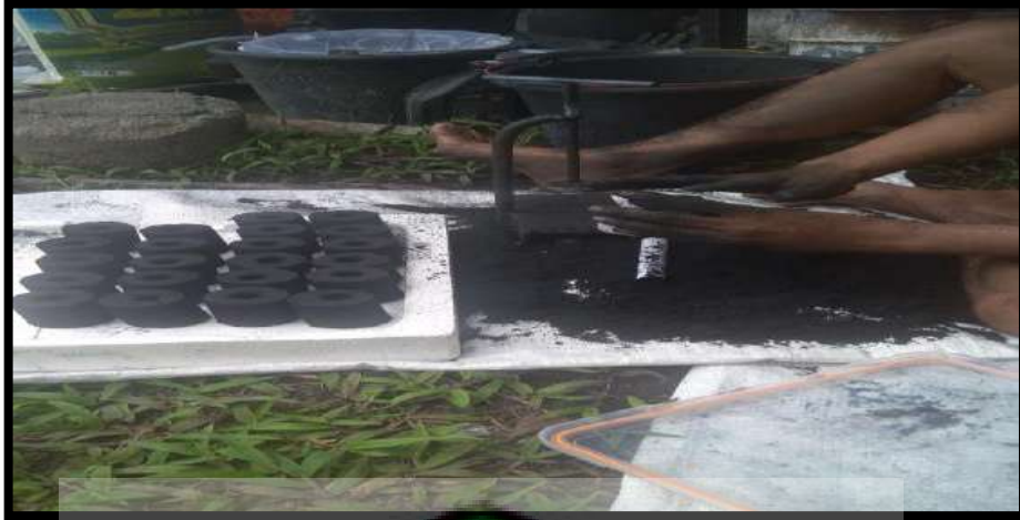
Gambar 4.13 Proses Pencetakan Briket.
